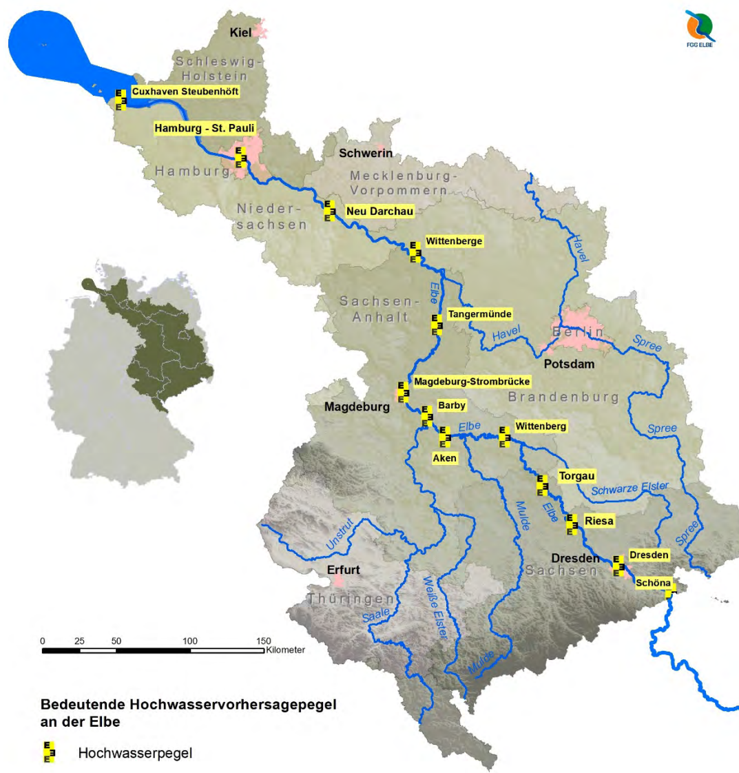
Abbildung 2-3: Bedeutende Hochwasserpegel an der Elbe
