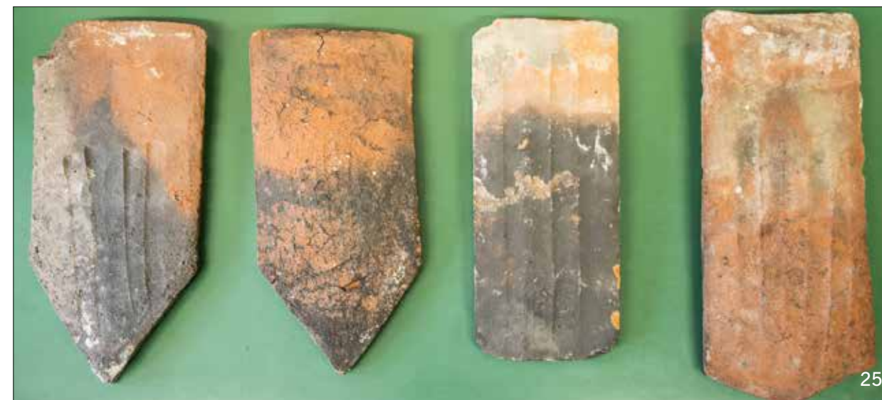
Abb. 25 historische handgestrichene Dachziegel aus dem Gebiet Sachsen-Anhalts (Auswahl)
